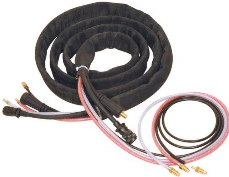
Jeu de câbles d'interconnexion refroidis par air de 10 m : câble de soudage 70 mm<sup>2</sup> avec TM (Mâle + Femelle), tuyau de gaz, câble de commande ArcLink 5 broches, gaine de protection.
