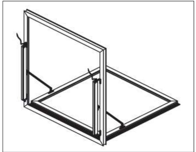
Installation SYNCHRO QUASAR DC PONT LEVIS sur châssis soufflet avec ouverture extérieure de 90°. Les boîtiers à chaîne ont une guide spéciale pour la chaîne. Contacter notre bureau d'études pour limitation d'installation (dimensions et poids de la fenêtre) et pour les étriers nécessaires à l'installation (sur la base du profil)
