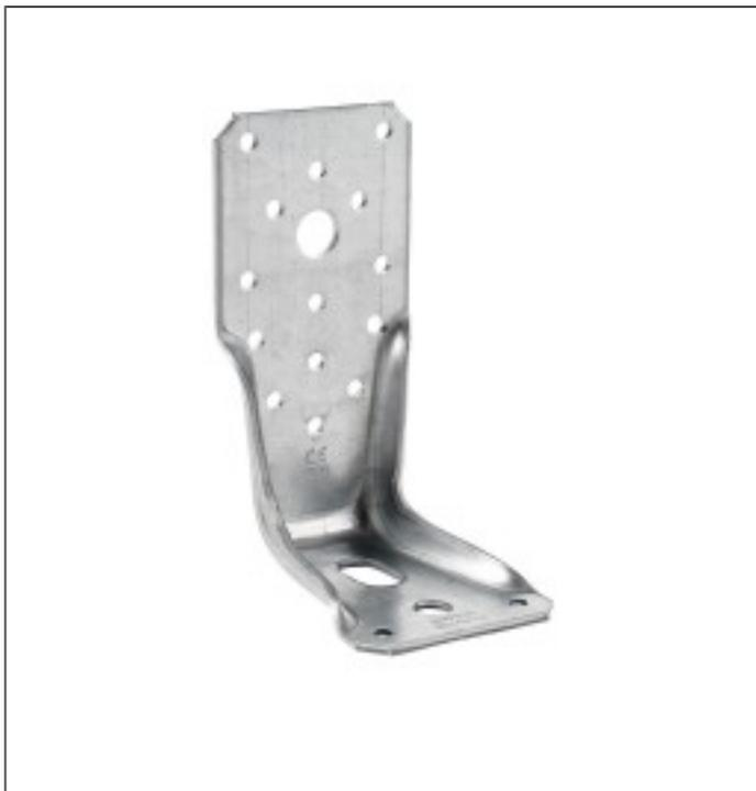
Les équerres renforcées pour ossature bois AKRX3 viennent compléter la gamme existante d'équerres renforcées offrant une reprise de charge importante en traction. Elles sont principalement préconisées pour la reprise d'efforts de soulèvement en pieds de murs à ossature bois.
