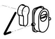
3- Installer l'ensemble sur la porte à l'aide des vis et piliers adaptés au perçage de la porte
