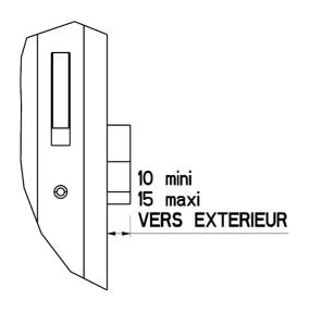
2- Fixer le protecteur sur le cylindre à l'aide des vis STHc M4 x 6
