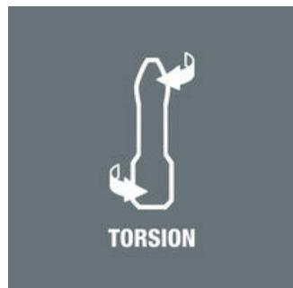
Les embouts Torsion sont des embouts avec en plus une zone de torsion. Ces embouts permettent d'amortir les pics de couple dans cette zone évitant ainsi l'usure précoce ; les embouts gagnent en longévité.
