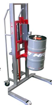
Idéal pour déposer ou retirer un fût sur un bac de rétention
