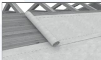
Respectez un recouvrement entre les lés de 10 cm si la pente est supérieure à 30%. Pour vous aider, suivez le marquage. Le recouvrement doit être de 20 cm lorsque la pente est inférieure à 30%.
