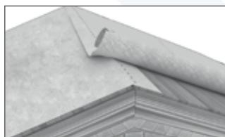
Le recouvrement à la faîtière, ainsi qu'aux coins, doit être d'au moins 20 cm.
