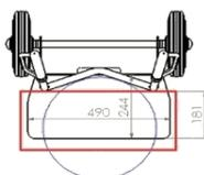
Tablier légèrement incurvé permettant le bon maintien de charges planes ou cylindriques.
