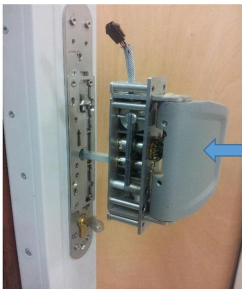
10- Placer le module « C » et sa tige carrée « D » dans le fouillot serrure.
