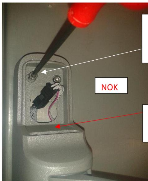
13- Fixer le capot central « E » avec 4 vis Chc M4 x 12. (Rep 6), couple **4 Nm**.
