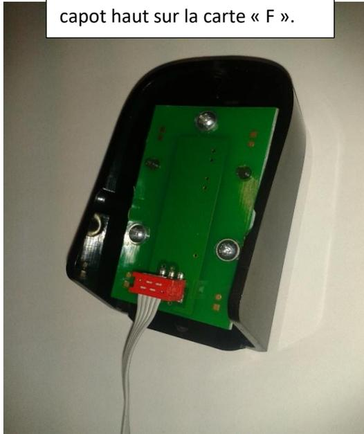
15- Fixer les capots haut « F » et bas « G » avec les vis M2.5x8 (Rep 7), couple **0.3 Nm Maxi.**
