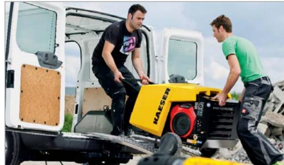
Les plus petits compresseurs MOBILAIR alimentent en air comprimé les bèches, marteaux, perceuses, scies, tournevis et ponceuses pneumatiques ou les fusées souterraines. La version à 15 bar est parfaite pour les tests d'étanchéité ou la pose de fibres optiques par portage à l'air. Un refroidisseur final d'air comprimé externe, proposé en option, permet d'obtenir de l'air comprimé frais et sans condensats.
