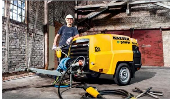
Les nouveaux compresseurs de chantier M 27E, M 31E et M 50E révèlent tous leurs avantages sur les chantiers disposant d'un raccordement électrique. Le moteur électrique silencieux leur ouvre l'accès aux zones à faibles émissions de gaz et aux zones réglementées en termes de bruit. Les utilisateurs de ces compresseurs dans les bâtiments ou les tunnels ne sont plus exposés aux émissions de gaz et moins soumis à de fortes nuisances sonores.
