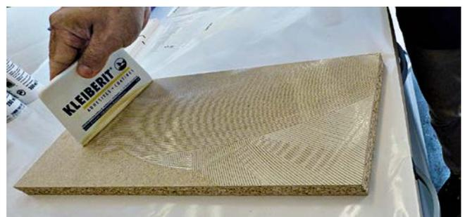
La colle est facile à appliquer avec une spatule, un pinceau, un rouleau ou une dépose automatique par buse.
