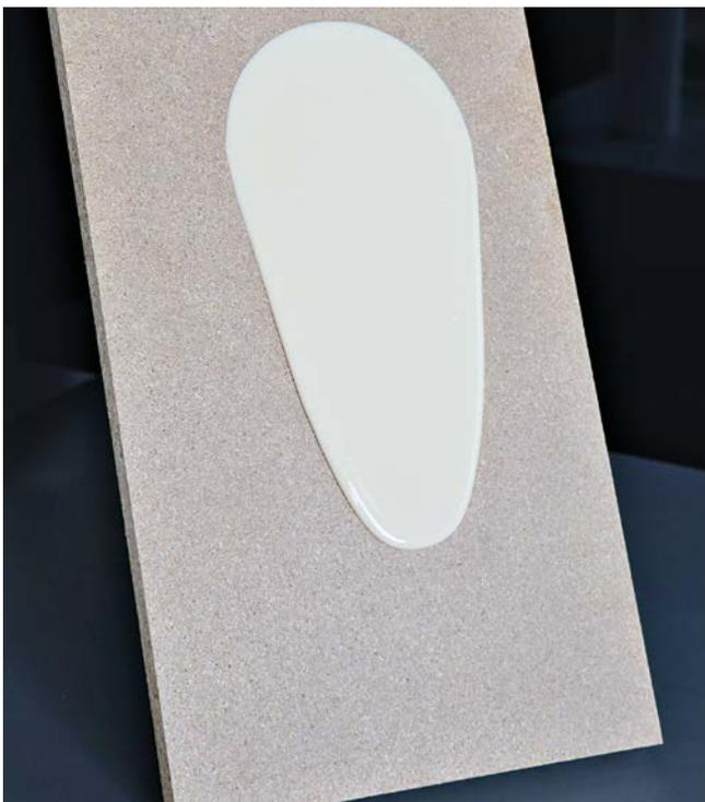
La viscosité ressemble à celles des colles en dispersion PVAc ou celle des colles PUR monocomposantes.
