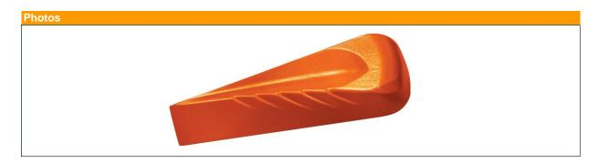
Forme hélicoïdale: favorise l'éclatement du bois. Tête arrondie pour éviter la projection d'éclats. Bord d'attaque droit: permet de choisir l'orientation de la fente. Large surface de frappe. Crans anti-retour: évite d'être rejeté lors de la frappe.
