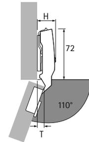
Retrait de charnière H / Retrait de porte T pour distance D = 0 mm et distance du boîtier C = 3 mm
