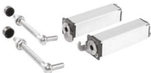
Charnières à ressort réglables pour portails de jardin et de promenade. L'ensemble peut être installé à l'intérieur d'un tube de 1-1/2", 16 Ga. Le SWING peut facilement être ajusté en force de l'extérieur au moyen d'une clé Allen.
