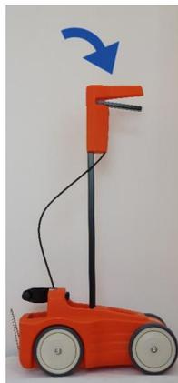
3- Insérer le timon verticalement dans le berceau sur le chariot.
