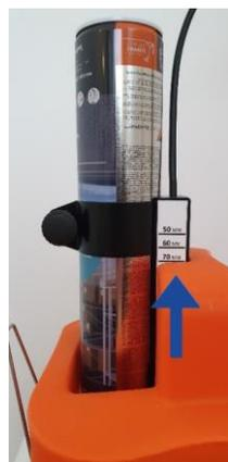
10- Ajuster la largeur du marquage en réglant la hauteur du support d'aérosol grâce à la vis-bouton placée à l'arrière de la coulisse.
