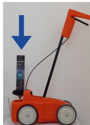
8- Insérer l'aérosol de Tracing PRO verticalement jusqu'à positionner la buse Soppec PureSPRAY™ dans l'actionneur.
