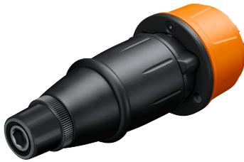
Butée de profondeur pour un vissage sans compromis. Permet d'enfoncer chaque vis exactement à la même profondeur. Course de réglage maximale de 12 mm avec 0,25 mm par cran pour une utilisation facile. Compatible avec toutes les visseuses sans fil FEIN dotées de l'interface QuickIN / QuickIN MAX.
