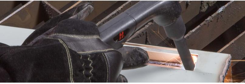
Des consommables brevetés plus longs et avec un profil étroit pour la coupe et le gougeage dans les endroits difficilement accessibles.
