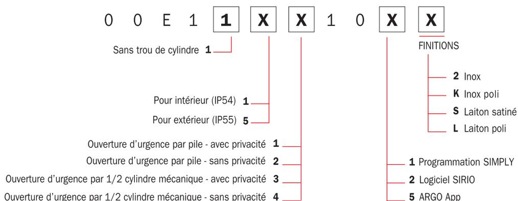
ARIES : ENSEMBLE PLAQUE BÉQUILLE ÉLECTRONIQUE AVEC DEMI-CYLINDRE MÉCANIQUE (non fourni) SANS FONCTION PRIVACITÉ
