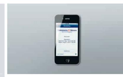
L'application MobileKey permet d'administrer de manière centralisée des systèmes de fermeture numériques décentralisés (cylindres numériques SmartCard, plaques béquilles numériques SmartHandle, SmartRelais 2 numériques, CompactReader). Grâce à ce système, ce sont les moyens d'identification (Smartphone), qui sont mis en réseau à la place des composants de fermeture. La mise en réseau avec le SW central d'administration (LSM) s'effectue via les réseaux de téléphonie mobile existants.
