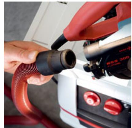
Non seulement les outils électroportatifs MAFELL mais aussi ceux d'autres fabricants se branchent sans efforts grâce à la pièce de raccord conique du tuyau.
