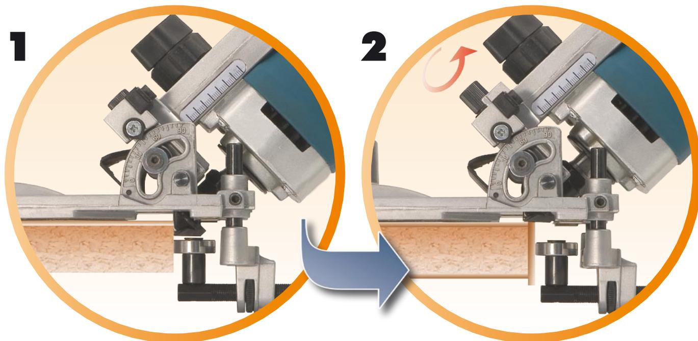
Il est possible de réaliser tout chanfrein à l'angle désiré ( $A^\circ$ ) entre 0 et 45° en inclinant la machine à l'angle souhaité. Pour cela repérer 45° et rajouter ( $A^\circ$ ) sur la graduation angulaire.
